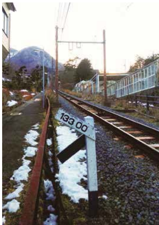
圖九 箱根登山鐵道索道線旁的坡度標示。本路段坡度為千分之133，全線最大坡度則為千分之200。鋼索鐵道上方的架線僅提供車內空調、照明與廣播使用，車輛則由鋼索牽引、車體本身沒有動力。
