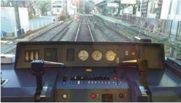
圖六 停靠在強羅站月臺最新型3000形電車駕駛座，有許多開關與儀表。行駛在登山鐵道上的車輛尺寸比較小，並有許多特殊設計如：多組剎車系統、灑水裝置等等。
