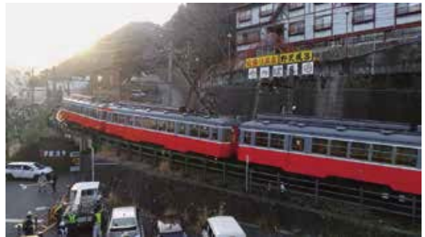
圖五 夕陽下奮力爬坡的老電車，一出箱根湯本就是千分之80的陡坡，同一節車廂的頭尾高度差達到一公尺；又因為急彎太多，箱根登山鐵道所有車廂之間都不設連通道。
